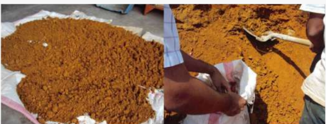
Residuo de Construcción tipo I (Suelo de excavación)
