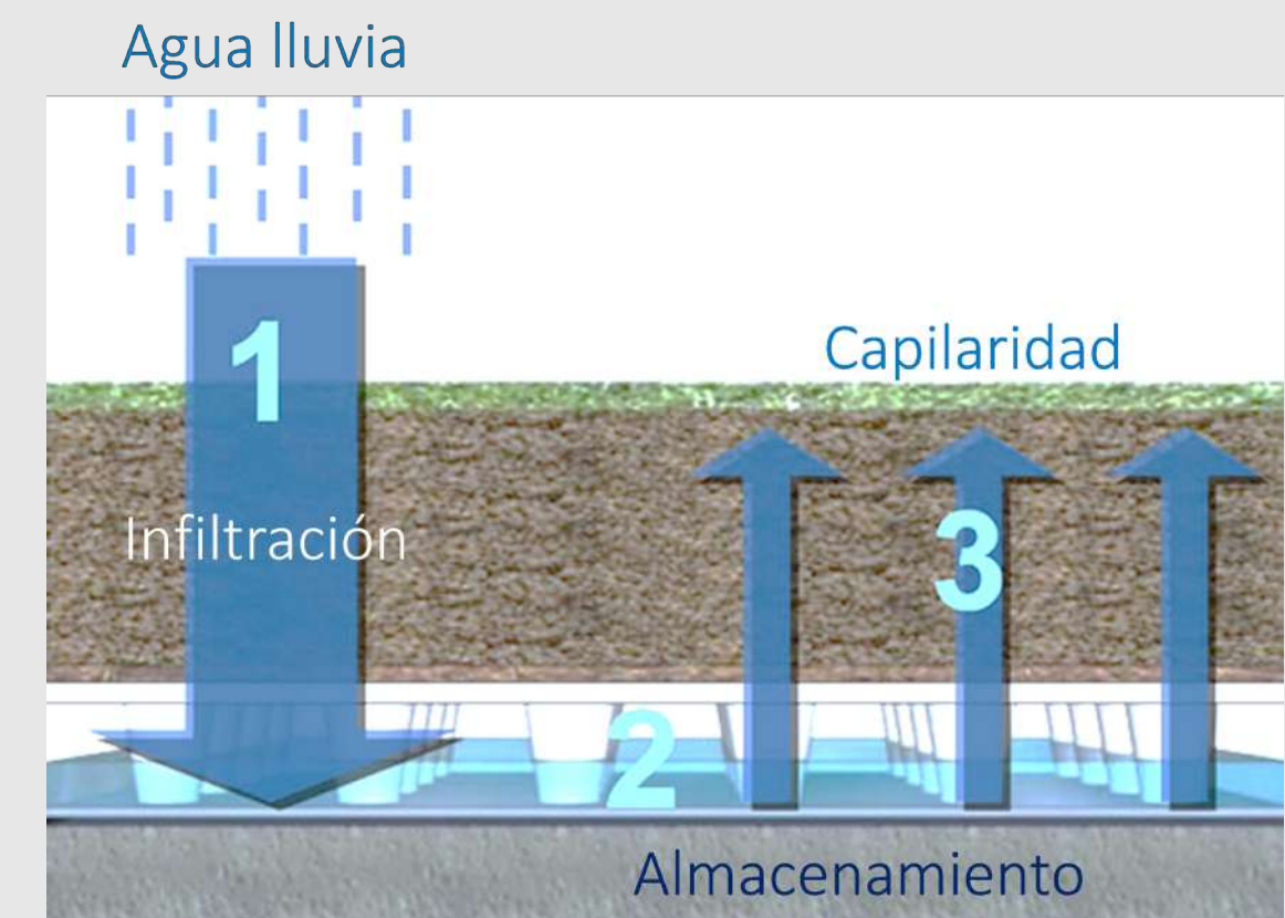
Figura 2. Jardín autoirrigado por agua lluvia y efecto de capilaridad Fuente: http://www.remaster.com.co/proyectos/proyectos.html
