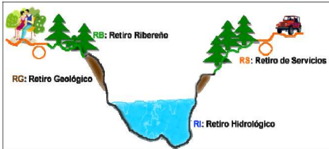
Figura 5. Sección transversal y franjas de retiro a corrientes hídricas
