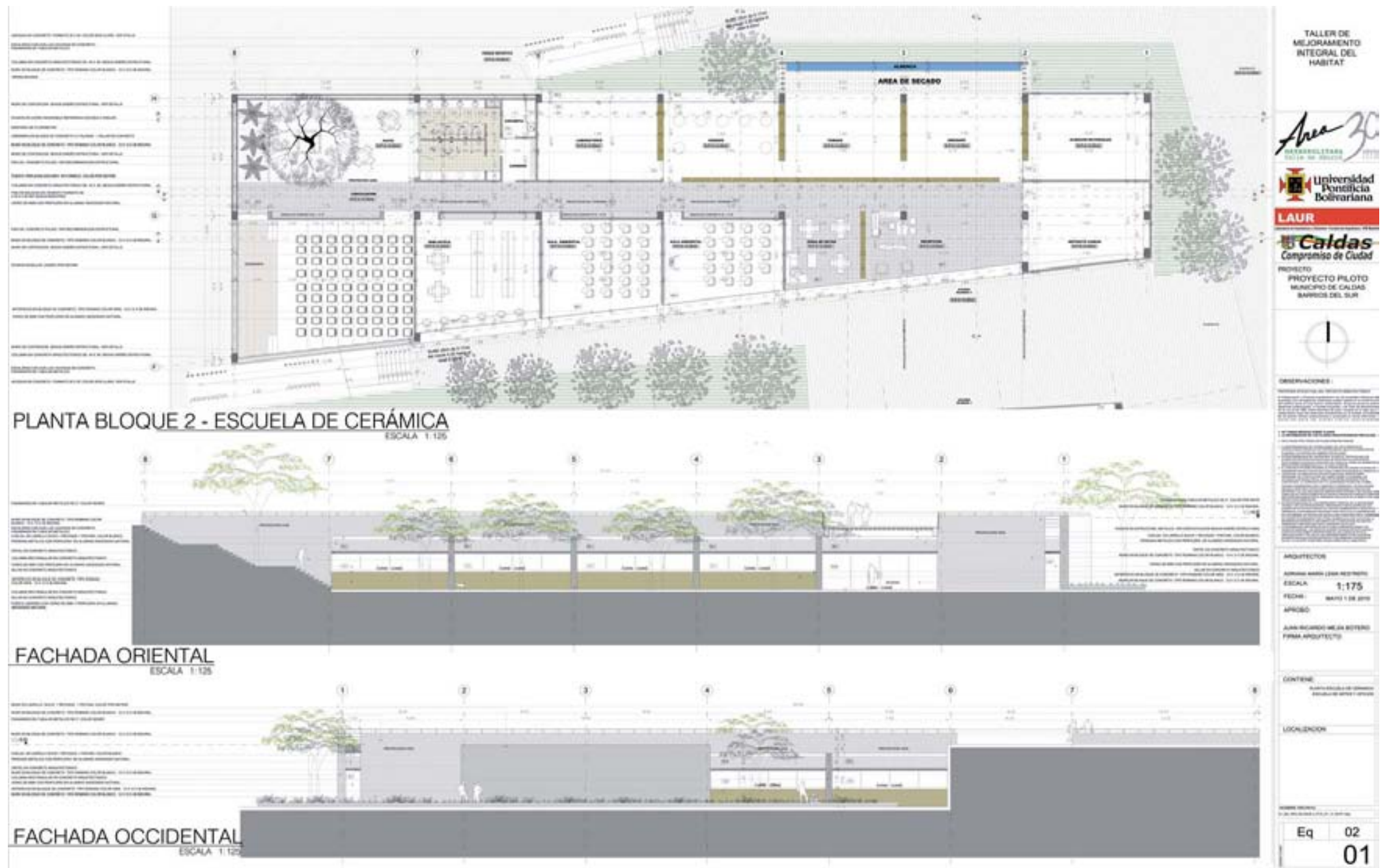
Imagen 18. Planta y fachadas bloque 2 edificio de equipamiento. Escuela de Cerámica
