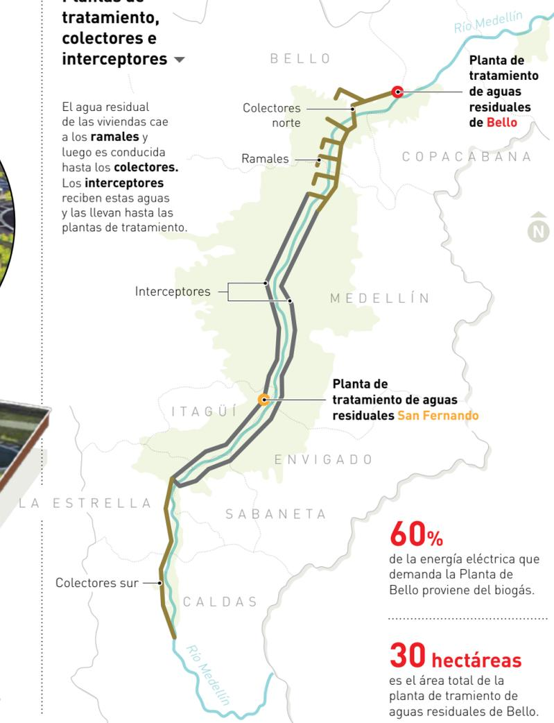
**60%** de la energía eléctrica que demanda la Planta de Bello proviene del biogás.
