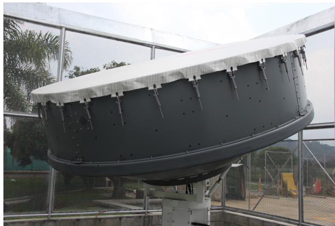
Figura 13.2: Radar Perfilador de Vientos RAPTOR VAD-BL.
