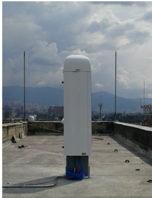
Figura 13.1: Ceilómetro Vaisala CL-51
