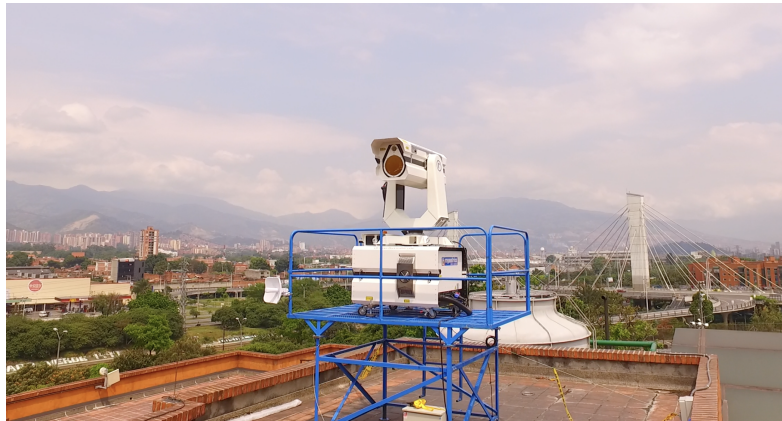
Figura 13.4: LR101-ESS-D200 elastic depolarization Scanning LIDAR.
