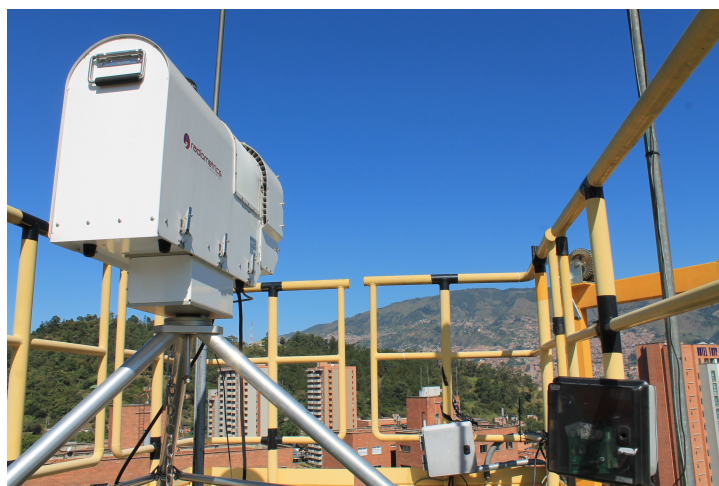
Figura 13.3: Radiómetro Microondas MP-3000A.
